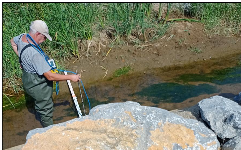
Figure 36 : Mesure des débits au courantomètre en sorte de station de relèvement des eaux pluviales
