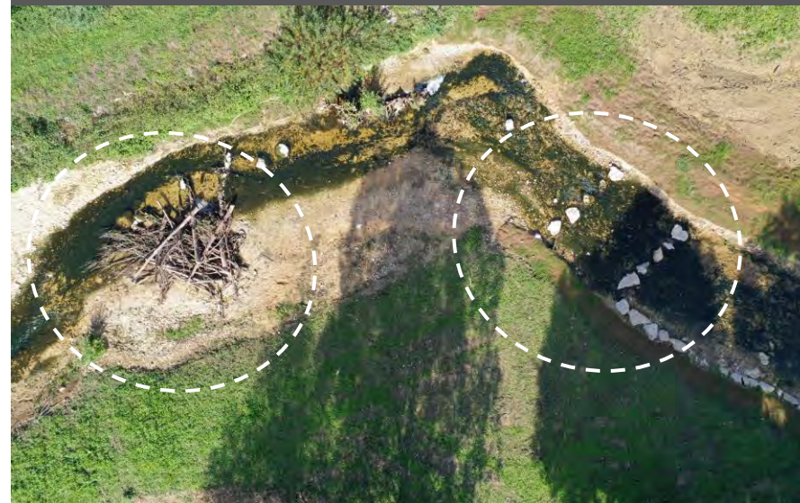
Exemple de création d'habitats additionnels et de diversification des faciès d'écoulement dans le Lange (SR3A, 01)
