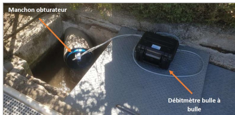
Figure 23 - Débitmètre utilisé pour la campagne de mesures
