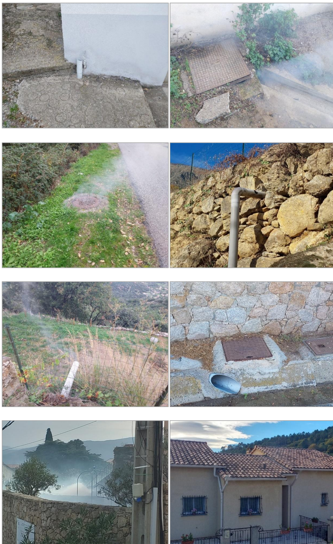
Planche 7 - Exemples des points d'entrée des ECPM identifiés lors des tests à la fumée
