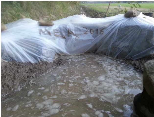
Figure Annexe 3.1: fermeture d'un canal pour test au bassin fermé, et sondes de pression utilisées (Diver® et Hobo®)
