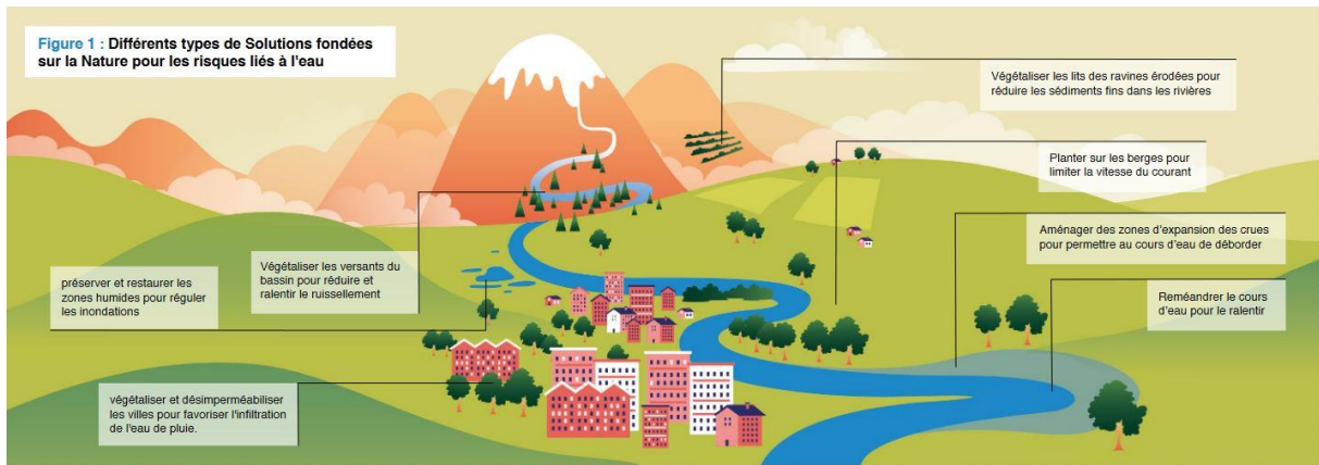
Figure 3 : Exemples de SfN pour les risques naturels liés à l'eau (source : UICN France, 2019)
