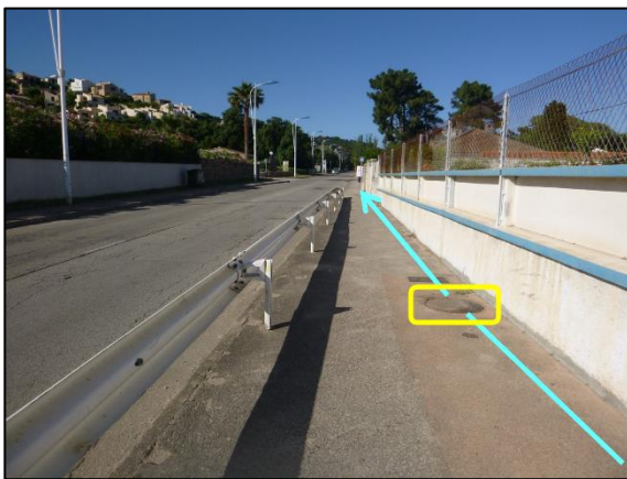
Photo 35 : Passage de conduite Fonte 150 → PVC 90 avec vanne de sectionnement (commune de GROSSETO PRUGNA)
