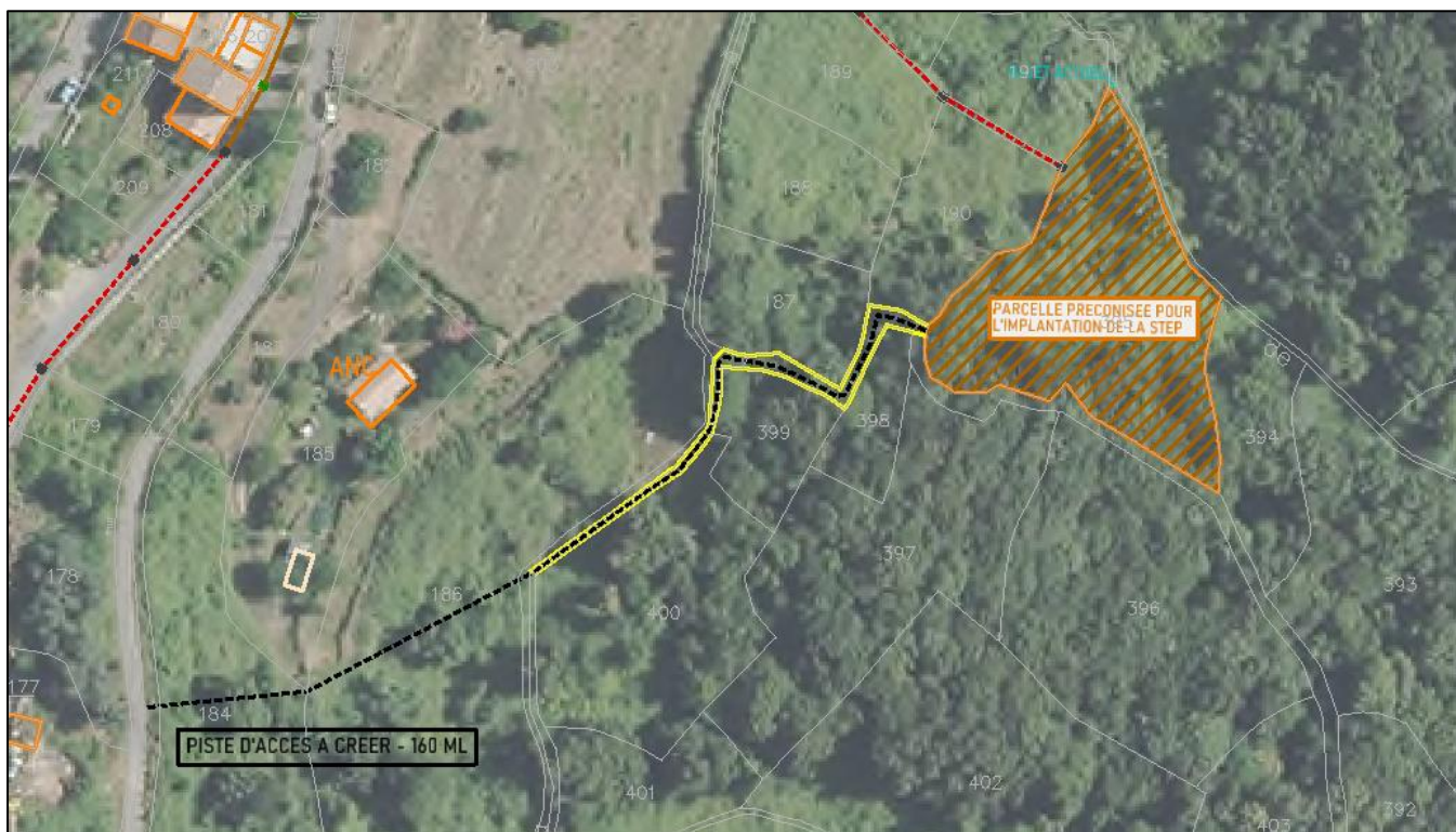
Figure 19 : Tracé de la piste d'accès à créer pour la station de traitement des eaux usées
