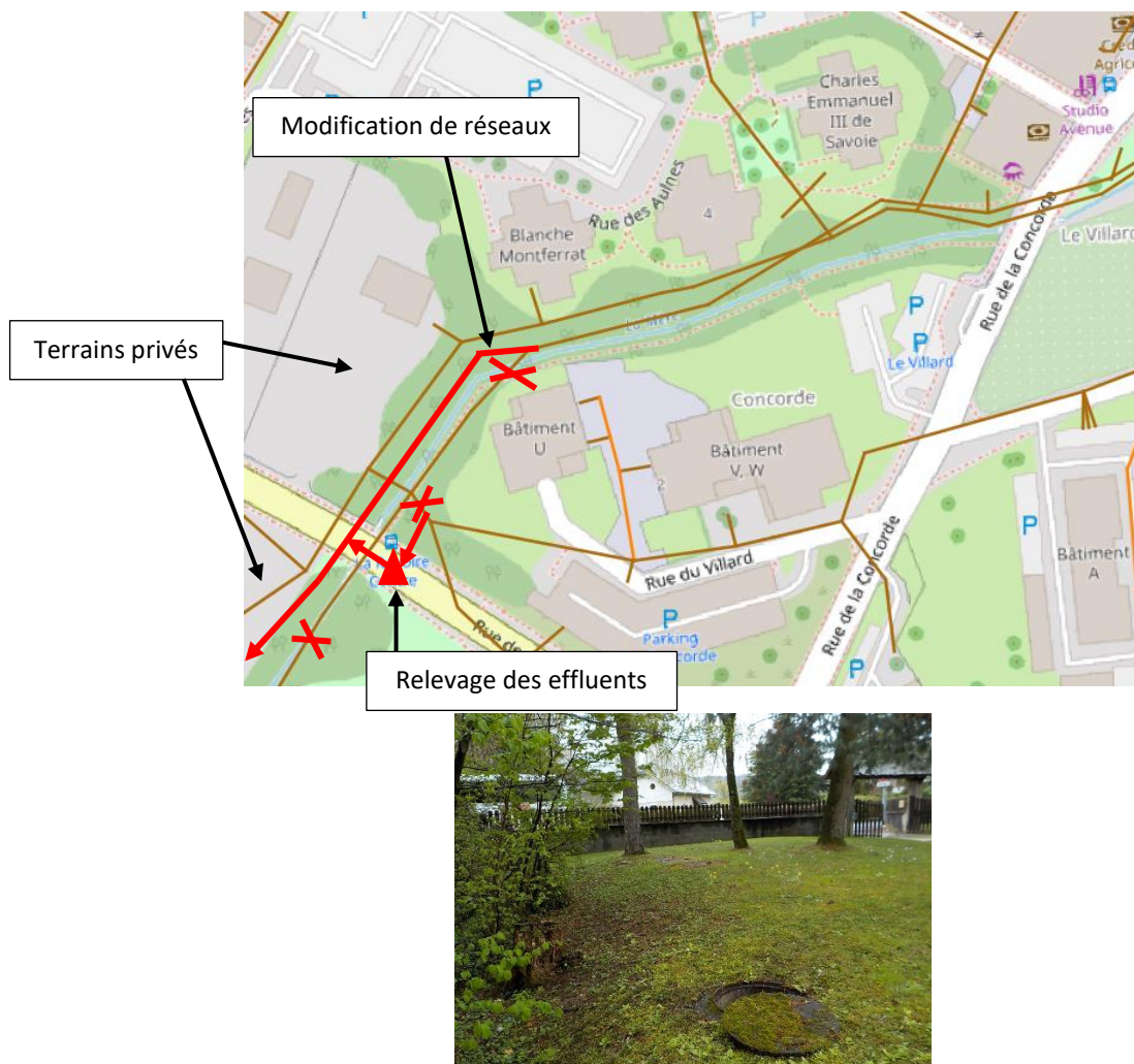
Figure 27 : Problématique foncière : réseau en terrain privé
