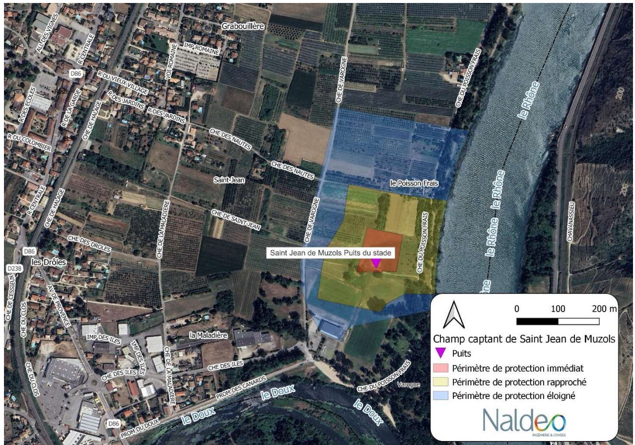
Figure 50 - Photo aérienne du champ captant de Saint-Jean-de-Muzols avec ses périmètres de protection
