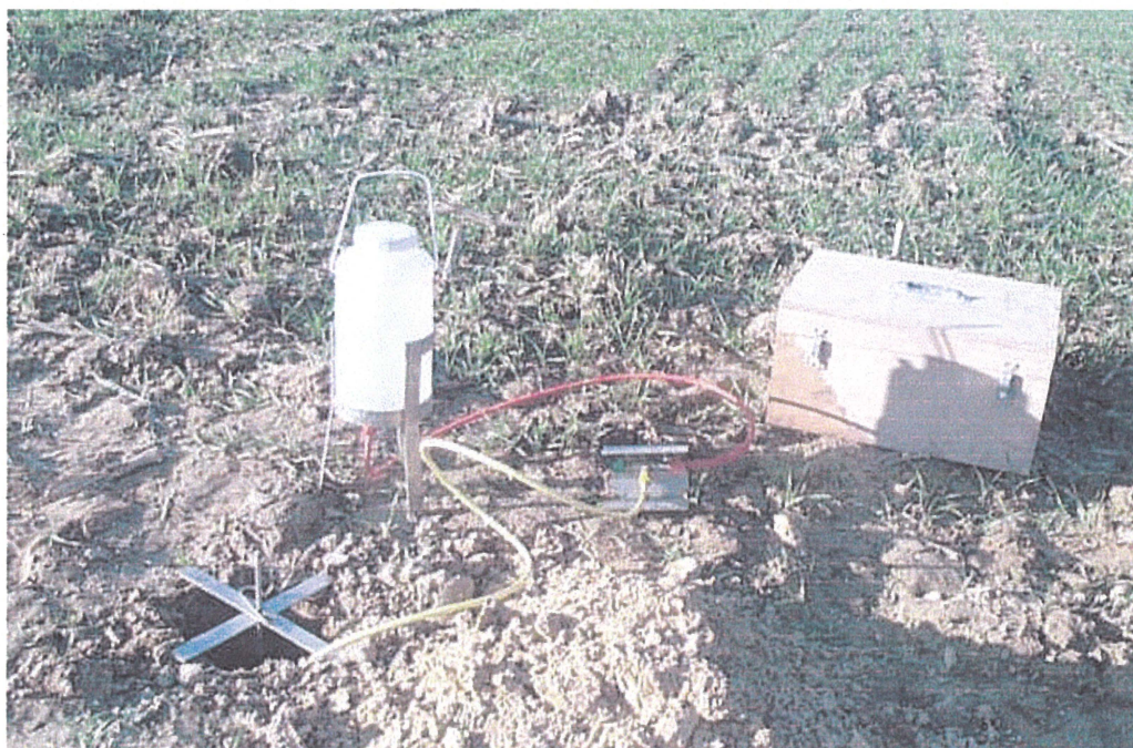
Fig. 3-A : Méthode de mesure de la perméabilité par le test de Porchet.
