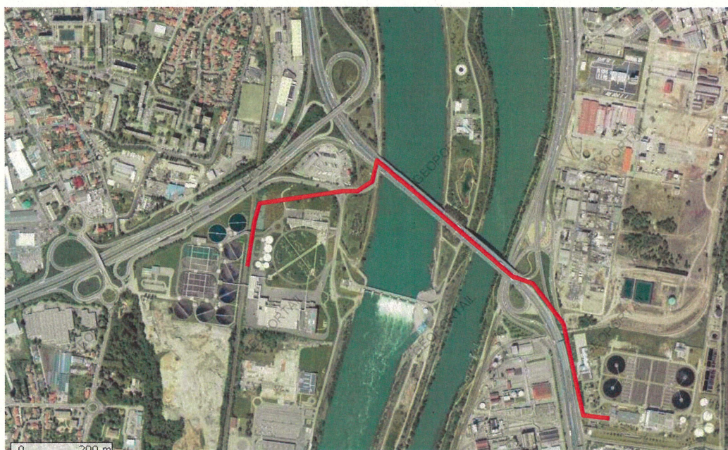
Figure 5-3 : Délestage de Saint-Fons vers Pierre-Bénite – Conduite en encorbellement
