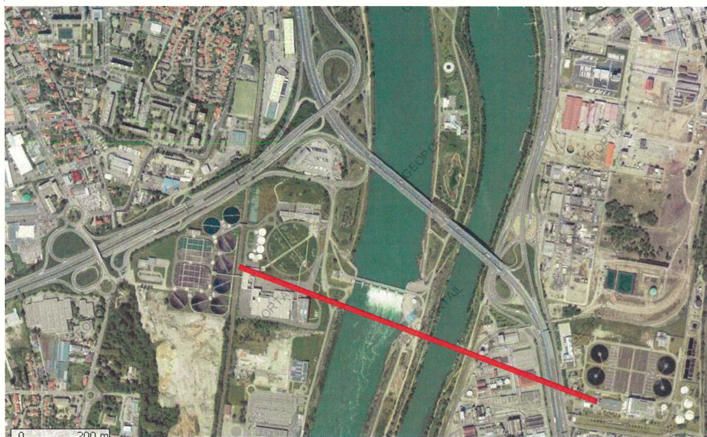
Figure 5-5 : Délestage de Saint-Fons vers Pierre-Bénite – Passage en tunnelier
