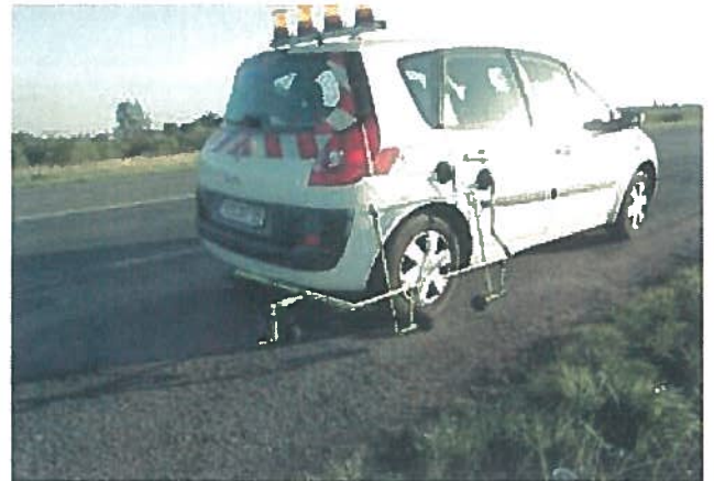
Illustration 7 : Véhicule de mesure de bruit de roulement en continu
