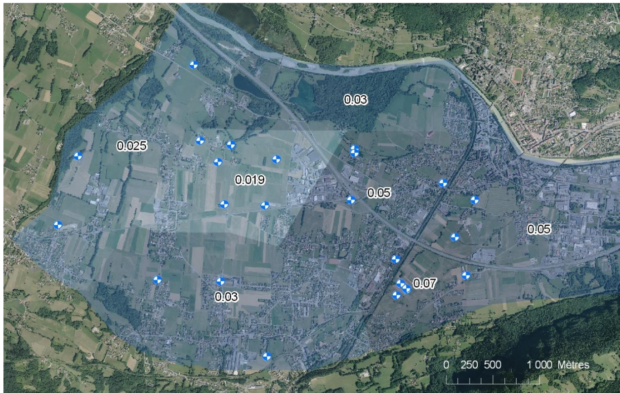
Communauté de communes du Pays Rochois. Mise à jour du modèle numérique de nappe du Cône de déjection du Borne. Figure 2-5 Champs des coefficients d'emmagasinement issus du calage du modèle. Fond Orthophoto.
