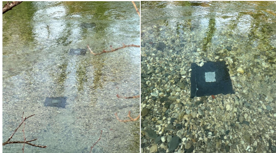
Figure 5 - exemple de plaques d'impacts installée sur la Bourne (Véodis-3D, 2024).
