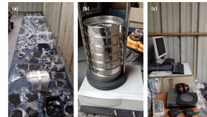
Figure 4 - Dispositif de tamisage et d'analyses granulométriques à sec (Source Véodis-3D).
