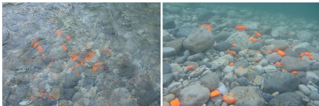
Figure 7 - Instrumentation de particules peintes (source Véodis-3D).
