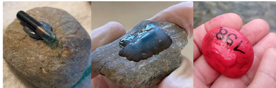
Figure 6 – Implantation de pit-tag sur les particules peintes (source ECOGEA).
