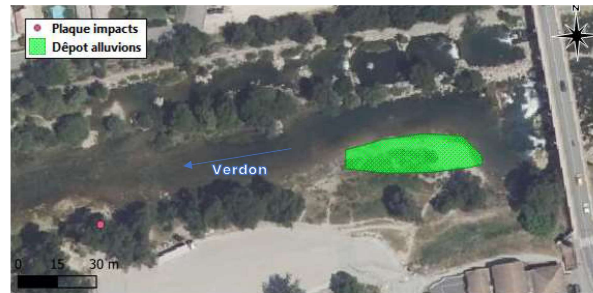
Figure 73 - Détail de l'implantation de la plaque d'impacts sur le Verdon (l'orthophotographie issue de la BD Ortho n'est plus d'actualité suite au passage de la crue de mars 2023).
