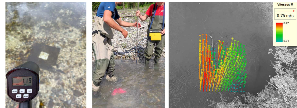
Figure 9 – Moyens utilisés pour les mesures de vitesse de courant de surfaces (source Véodis-3D).
