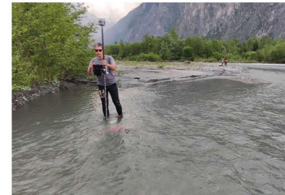
Figure 3 - Levés par GNSS RTK (précision centimétrique).
