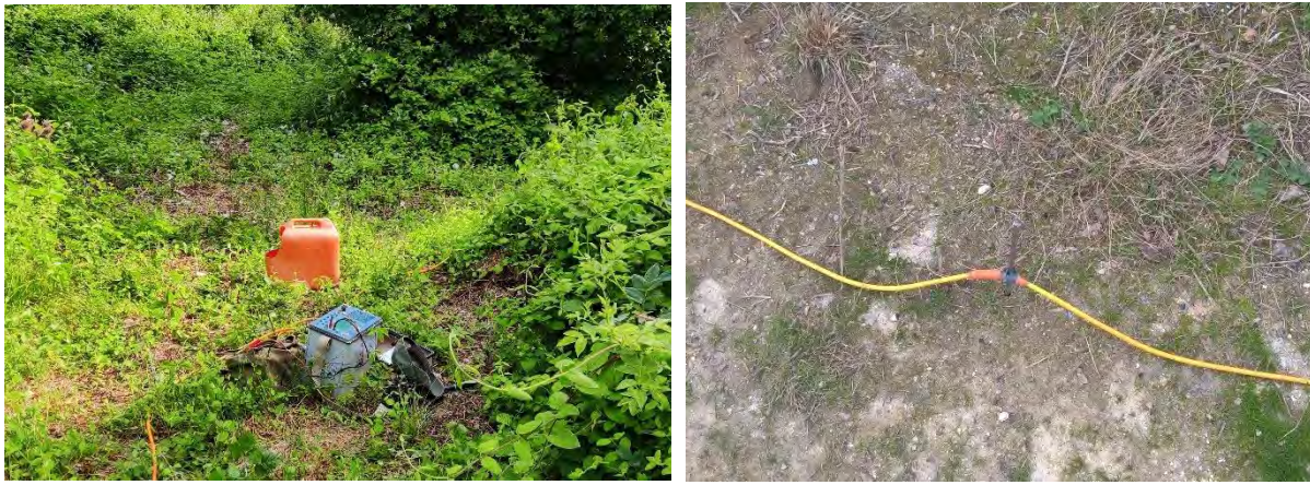
Photographie 1 : Détail de l'équipement panneau électrique Syscal Pro Switch, 72 électrodes
