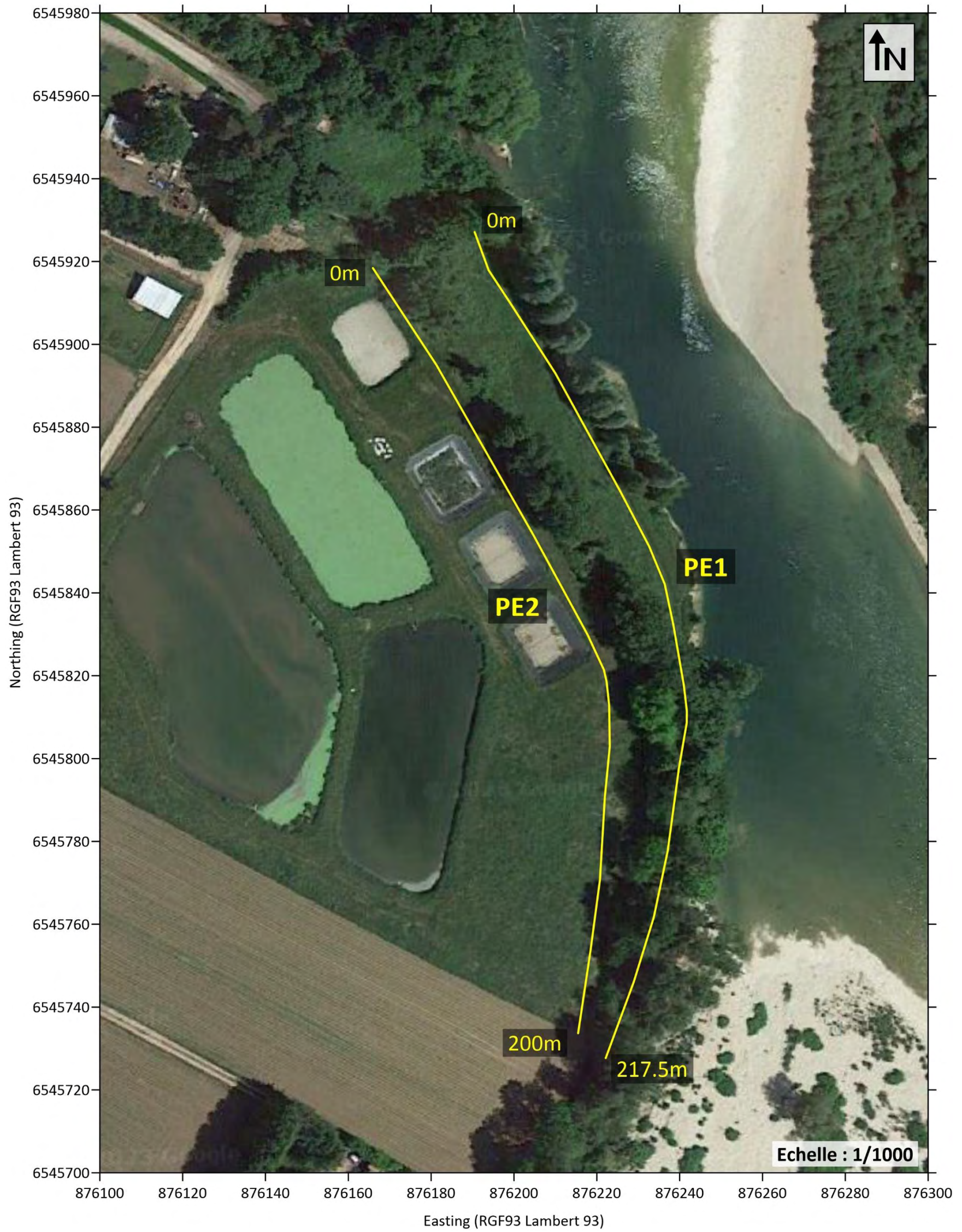
Planche 1 : Implantation des profils électriques ; échelle 1/1000
