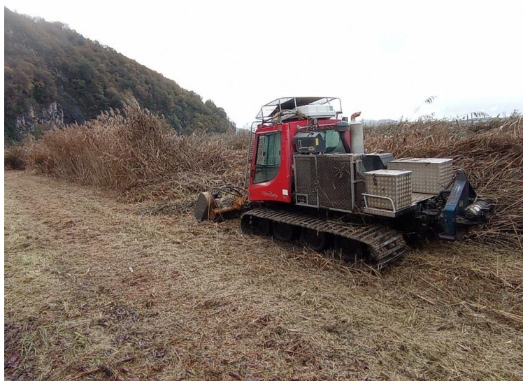
Figure 79 : Broyage des végétaux sur sol à faible portance (chantier SAGE)
