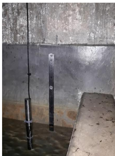
Exemple de mesure de débit sur un captage avant trop plein
