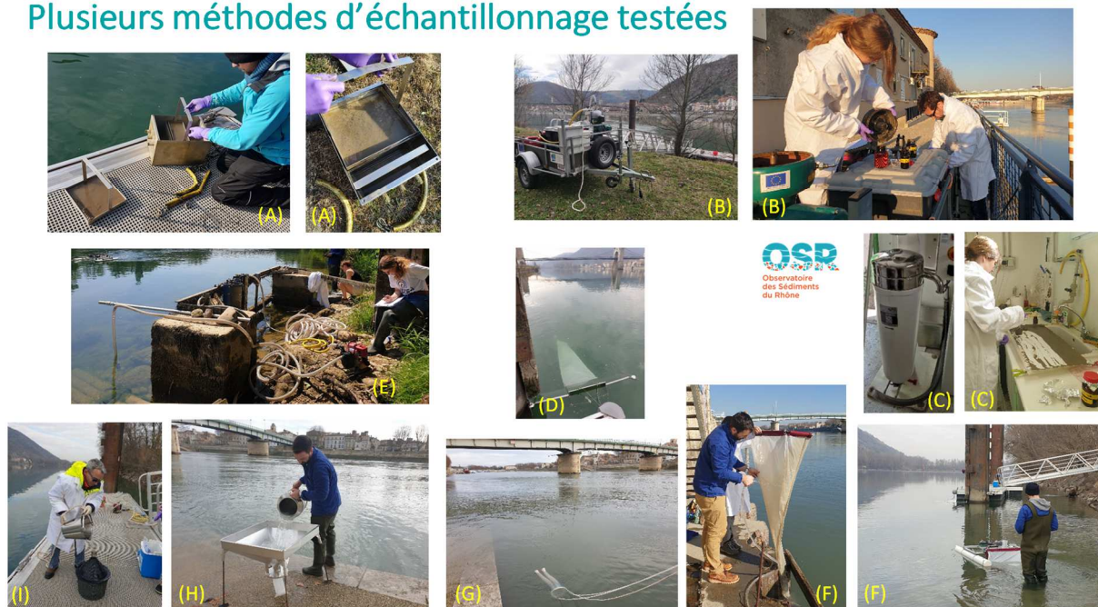
Figure 2 : Illustration des méthodes d'échantillonnage testées sur le Rhône à Arles et Andancette. (A) : piège à particules - PAP ; (B) : centrifugeuse mobile - CMO ; (C) : centrifugeuse fixe - CFI ; (D) : filet Manta 300 \mu\text{m} ; (E) : pompage + mini-filet 50 \mu\text{m} ; (F) : filet 50 \mu\text{m} sur drone aquatique ; (G) : Babylegs ; (H) : manuel + mini-filet 50 \mu\text{m} ; (I) : manuel nanofiltration. Photos : INRAE-RiverLy.
