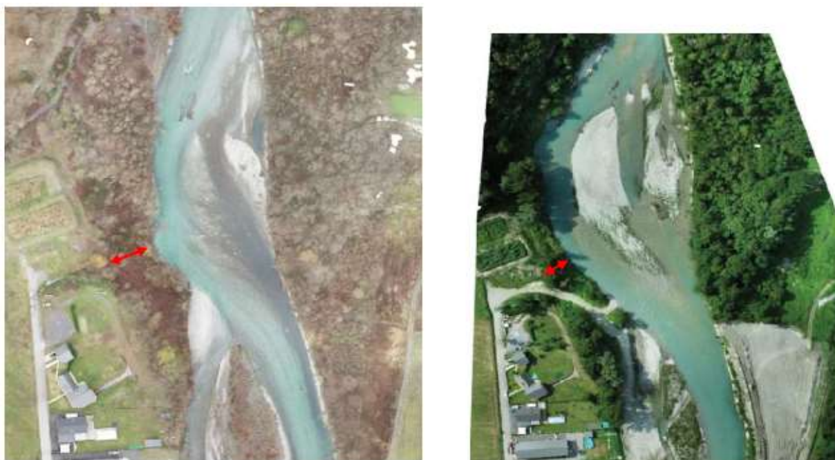
Figure 123 : Vue aérienne de l'érosion de berge entre (Décembre 2019 à gauche et juillet 2021 à droite)
