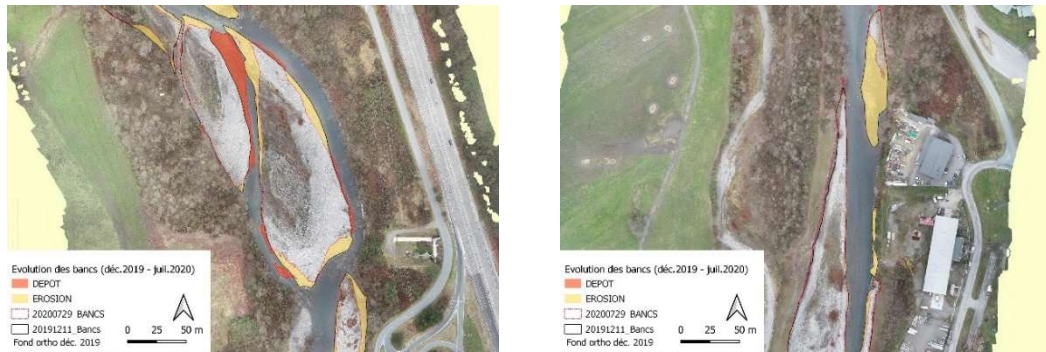
Figure 59 : Exemple d'évolution (surfaces en accrétion / surfaces soustraites) sur le site de Langon entre décembre 2019 et juillet 2020 pour des hauteurs d'eau similaires
