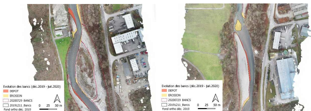
Figure 63 : Exemple d'évolution (dépôt / érosion) sur le site des Vernays entre décembre 2019 et juillet 2020 pour des hauteurs d'eau similaires
