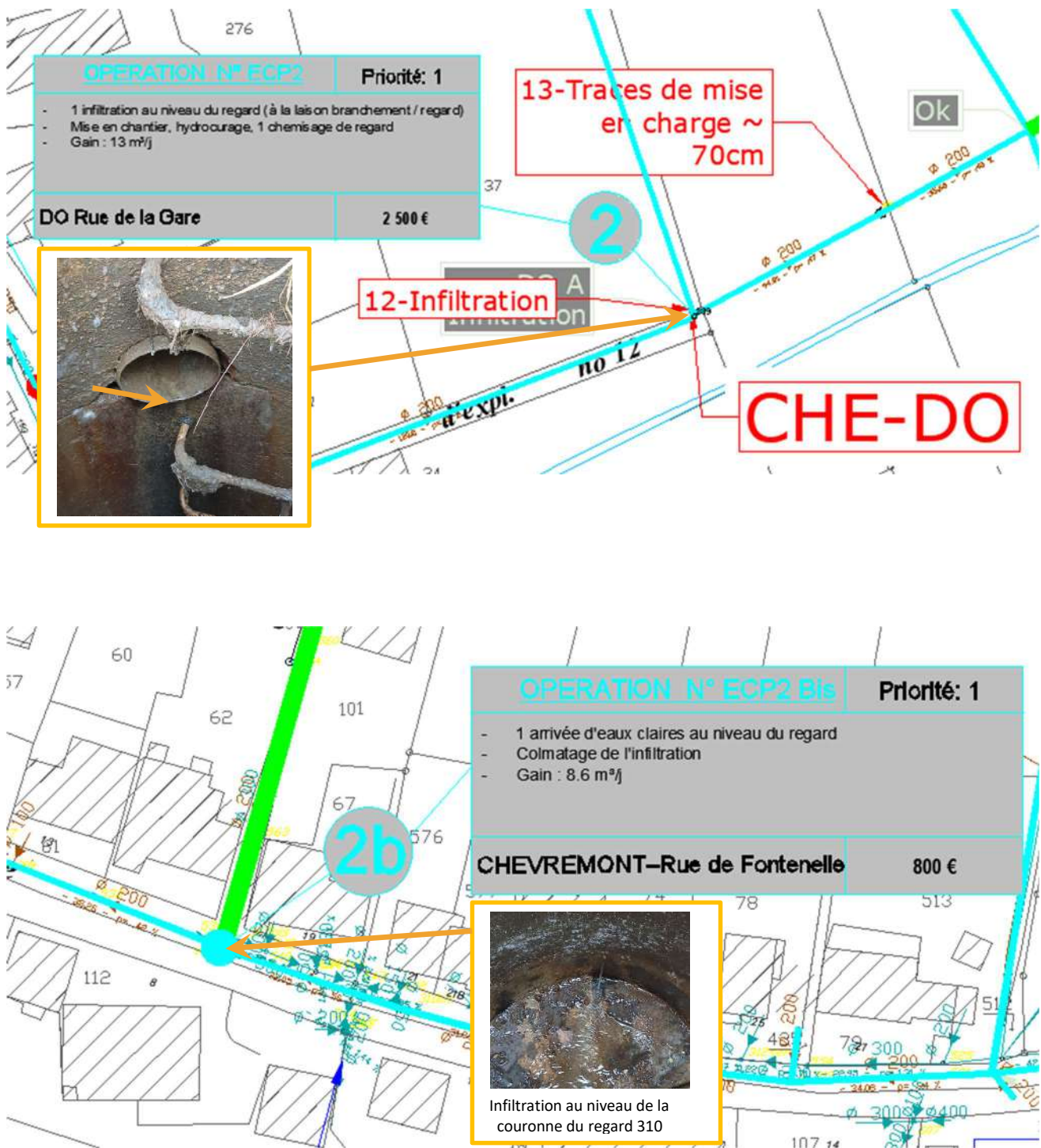
Figure 4 : Localisation des regards générant des infiltrations
