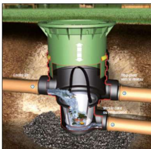
Figure 13: Exemple de regard d'infiltration (documentation GRAF)
