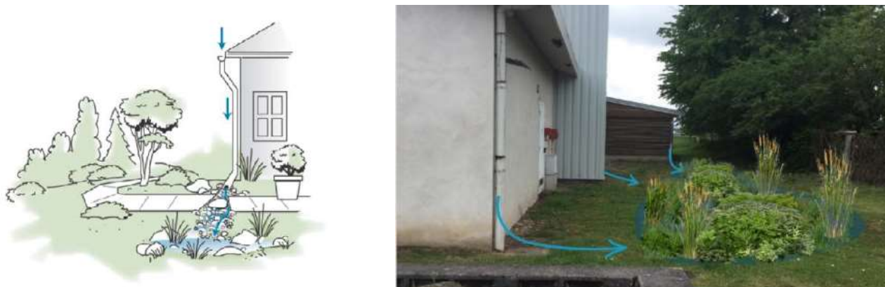
Figure 10 : Infiltration par noues
