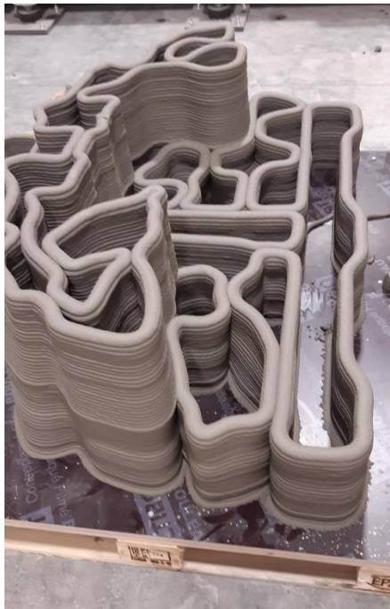
Figure 42 : détail d'un demi module imprimé (détail coupes réalisées)
