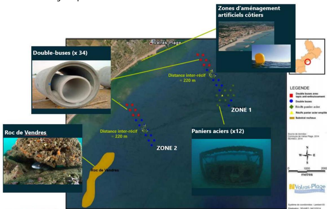
Figure 3 : Schéma d'implantation des récifs artificiels au large de la commune de Valras-Plage dans la concession d'implantation des récifs artificiels établie sur 30 ans (2006 – 2036) par arrêté Préfectoral 2006-01.1989
