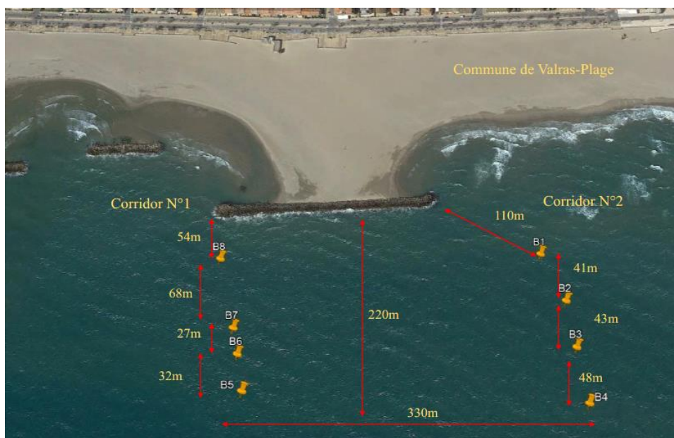
Figure 52: Plan de situation du balisage des 300m au droit de la commune de Valras-Plage. Les points identifiés de 1 à 8 représentent la position spatiale des corps-morts éco-conçus faisant l'objet de la présente demande d'AOT (Carte IGN).
