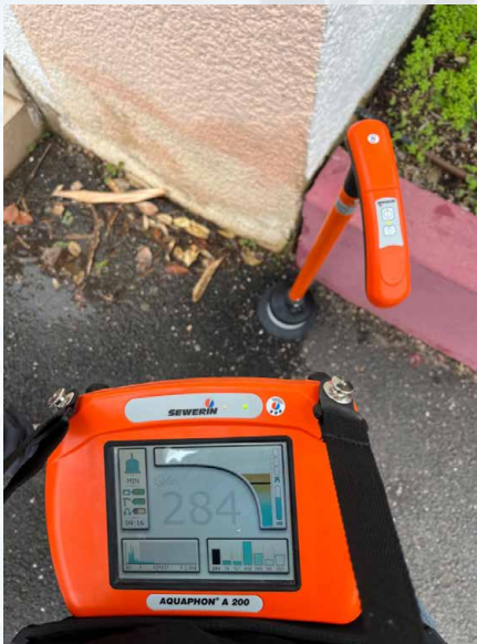
La recherche de fuite acoustique est réalisée en utilisant l'aquaphon A200.
