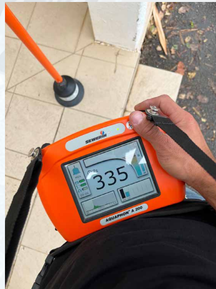
Des signaux acoustiques anormaux ont été enregistrés, ce qui laisse supposer la présence potentielle d'une fuite dans les canalisations.
