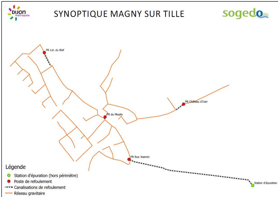
Figure 3 : Synoptique du système d'assainissement de Magny-Sur-Tille
