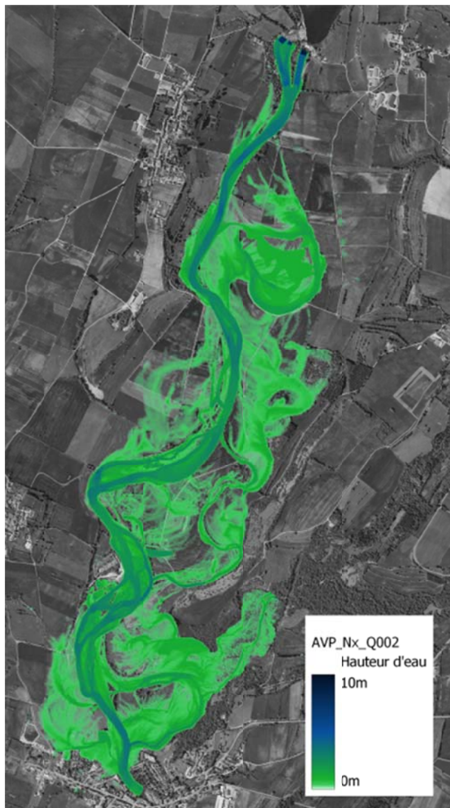
Figure - 32. Débordements à Q2 après travaux
