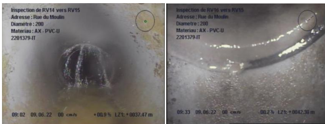
Figure 2 : Illustration d'une intrusion d'eaux claires parasites par branchement – Rue du Moulin
