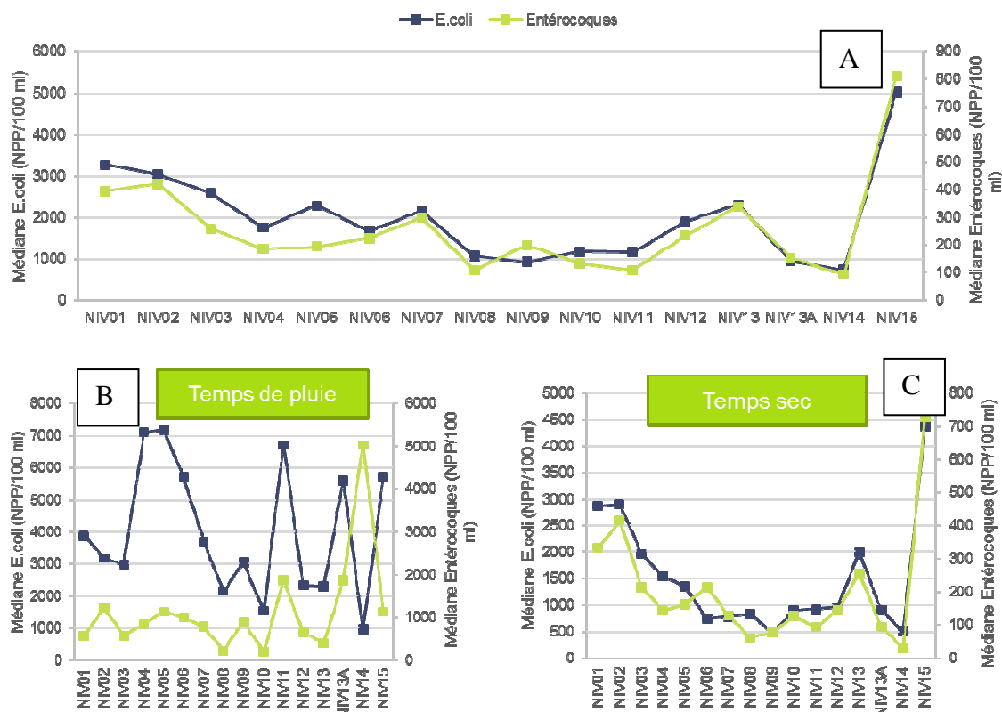
Figure 45 : Profil bactériologique de la Nivelles toutes campagnes confondues (A), par temps de pluie (B), et par temps sec (C) aux points de suivi de la CAPB (Source : CAPB, Mise en forme : Suez Eau France)
