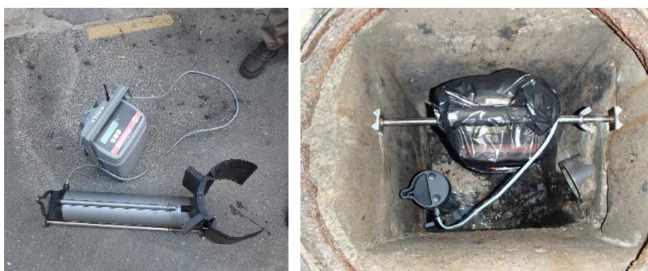
Figure 1 : Photos du piège et de sa mise en place pour la dératisation mécanique des réseaux d'assainissement.
