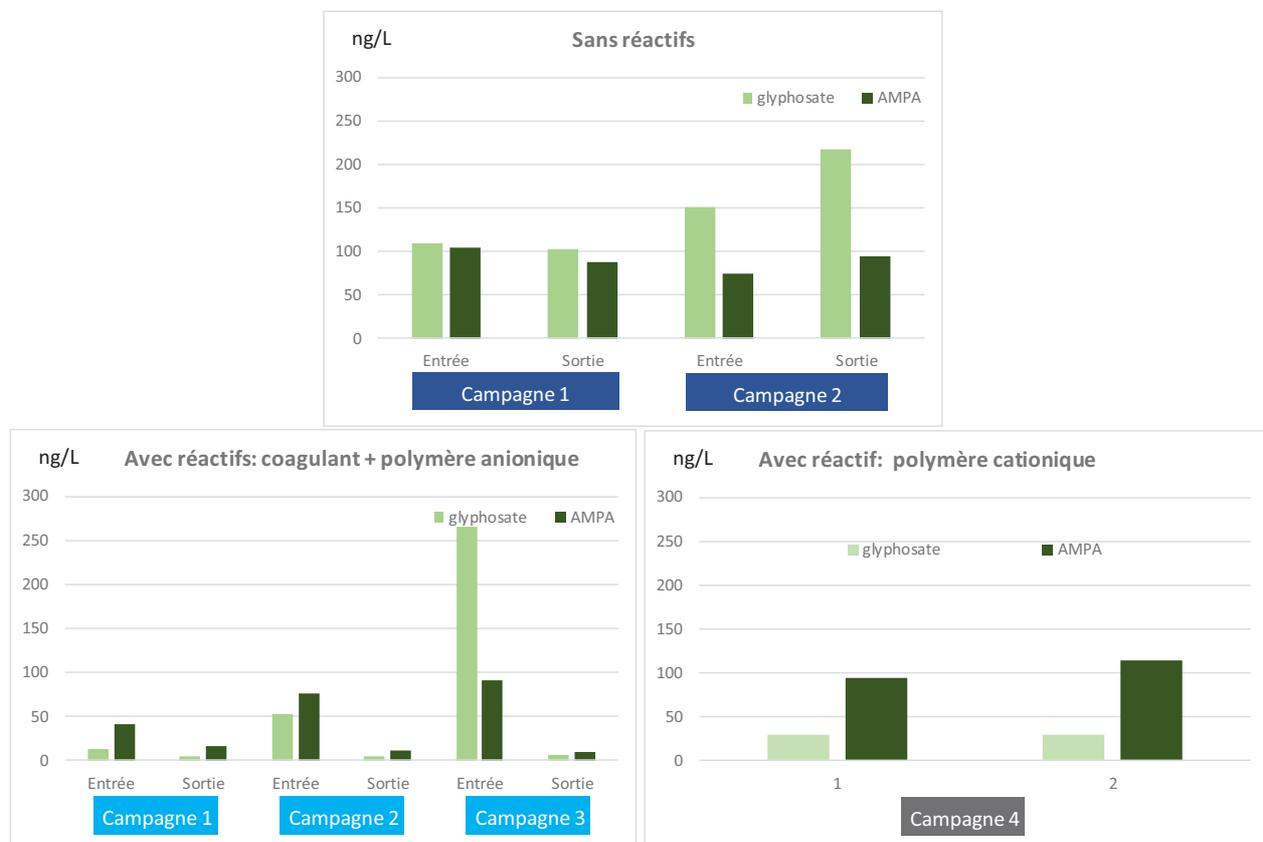
**Figure 32 : Concentrations en glyphosate et AMPA en entrée et sortie pilote pour les 6 campagnes de temps de pluie.**
