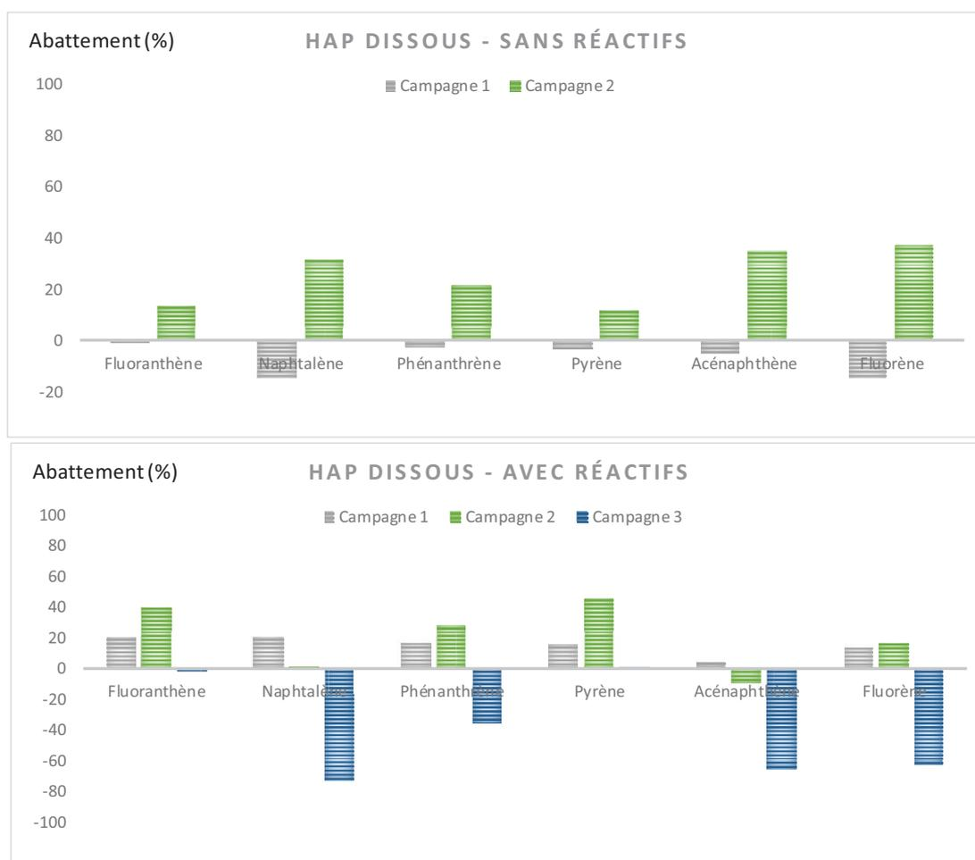
**Figure 21 : Abattements pour les HAP dissous sur la filière pilote dans les campagnes de temps de pluie sans réactifs (haut) et avec réactifs (coagulant + polymère anionique, bas)**
