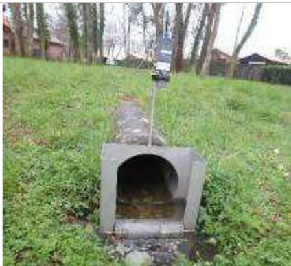
Figure 12 - Germignan amont : Boite déversoir à échancrure rectangulaire
