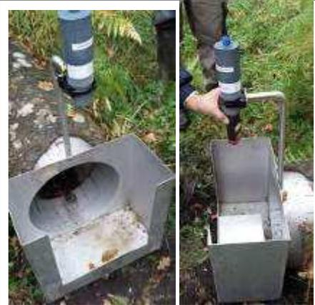
**3) Installation d'un piézomètre de manière à mesurer le marnage du bassin (pour les fortes pluies car il semble avoir sinon de bonnes capacités d'infiltration)**
