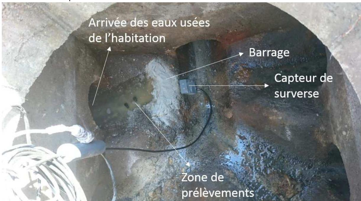
Figure 11. Dispositif expérimental mis en place dans le réseau d'assainissement
