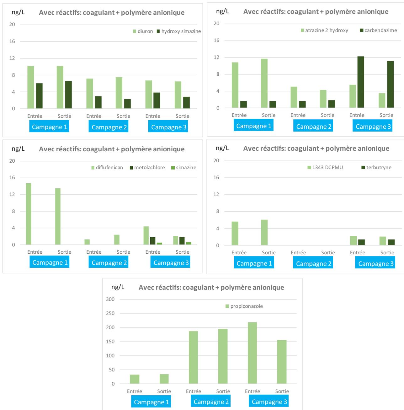
Figure 28 : Concentrations en pesticides entrée et sortie du pilote. Traitement avec réactifs : coagulant et polymère anionique
