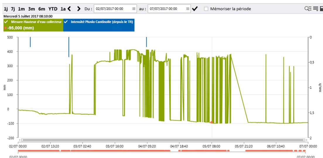
Figure 18 - Exemple de dysfonctionnement de la mesure de hauteur d'eau sur le site de Germignan
