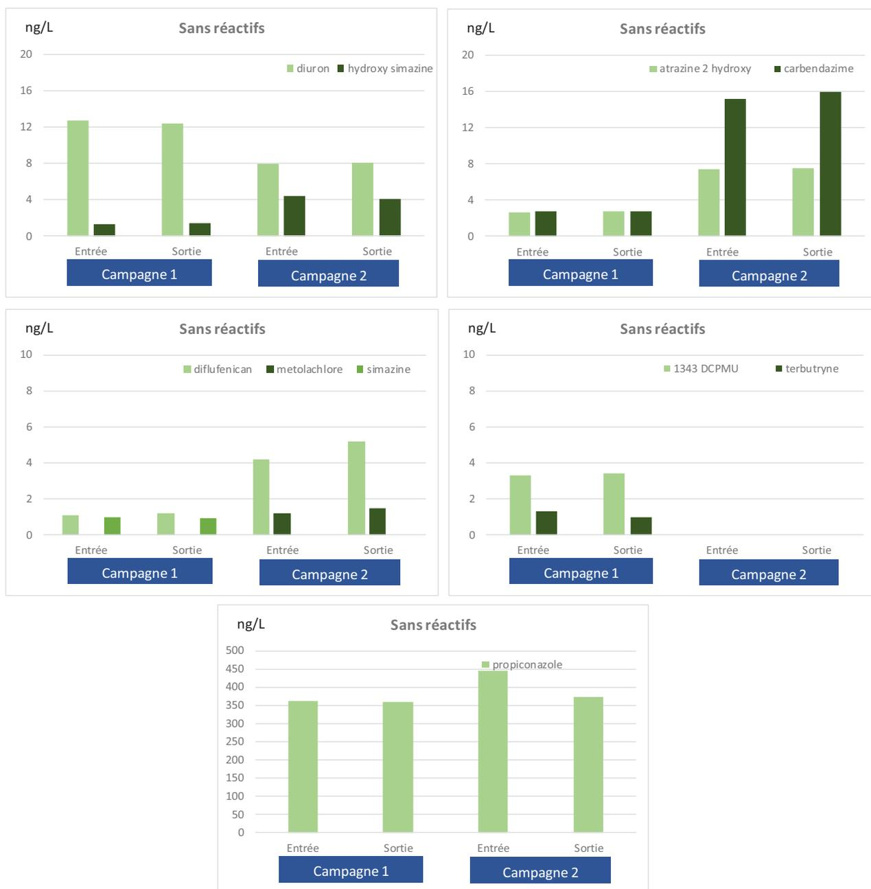
Figure 26 : Concentrations en pesticides entrée et sortie du pilote fonctionnant sans réactifs
