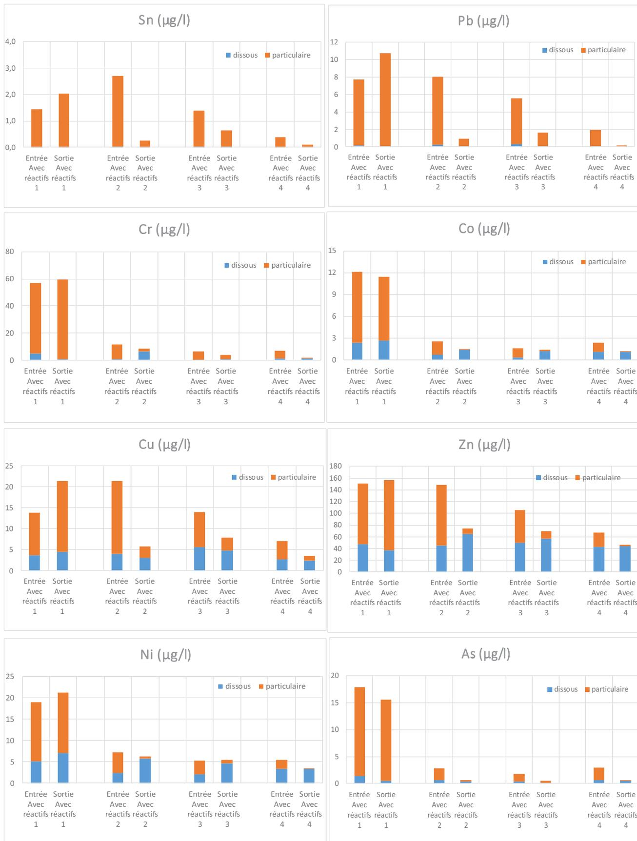
Figure 36 : Concentrations en éléments traces métalliques entrée et sortie du pilote fonctionnant avec réactifs (Campagnes 1 à 3 : coagulant + polymère anionique ; Campagne 4 : polymère cationique)
