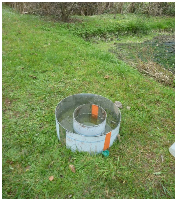
Figure 42 : Photographie de l'infiltromètre double anneau standard
