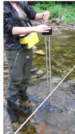
*Courantomètre électromagnétique Hydreka BFM01*
