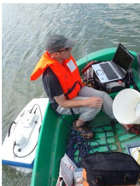
Les résultats des mesures sont contrôlés en cours de réalisation à l’aide d’un logiciel dédié, dont le débit au droit du site, et le post-traitement des données permettra une restitution du profil des vitesses et de la bathymétrie le long de chaque section mesurée.
