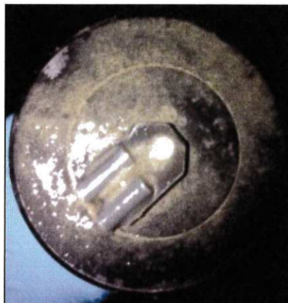
Problème lié à un développement de biofilm sur la sonde
