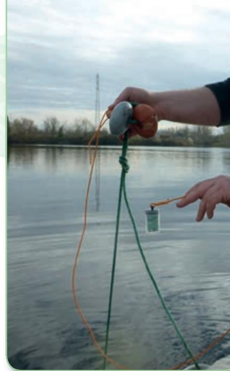
Installation d'un capteur enregistreur de température de l'eau dans le lac de Lamartine
