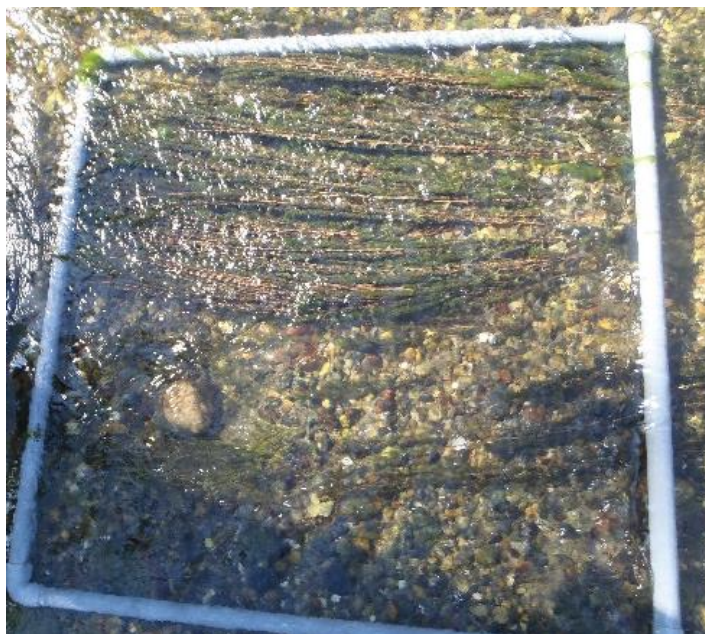
Figure 12. Quadrat en PVC utilisé pour délimiter une zone de 1 m 2 , ici dans une zone d'eau courante peu profonde (photo : R. Archambeau).
