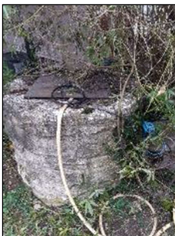
Figure 4 : Mesure de la hauteur de la nappe alluviale
