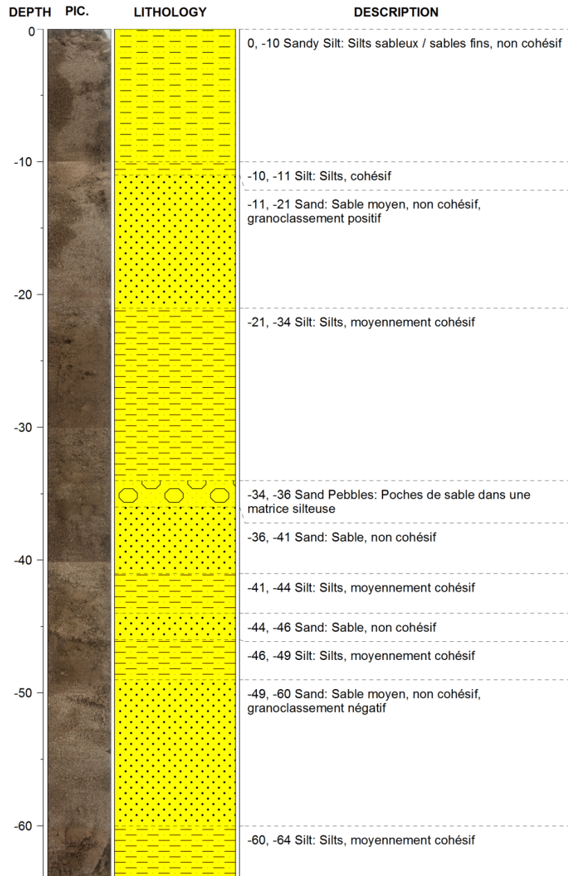
Figure 17 : Description sédimentologique de la carotte DZR_1602
