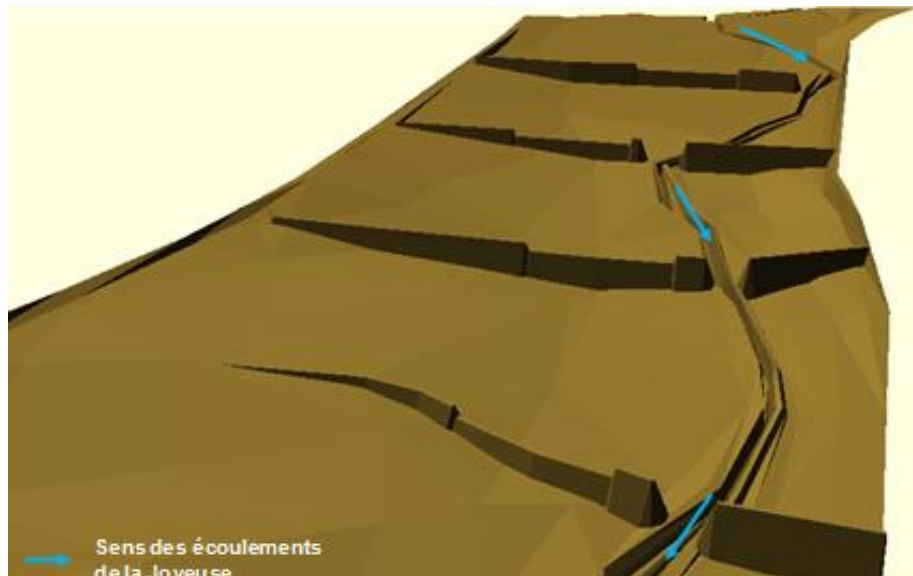
Figure 29 : Représentation 3D des casiers (vue depuis l'aval)
