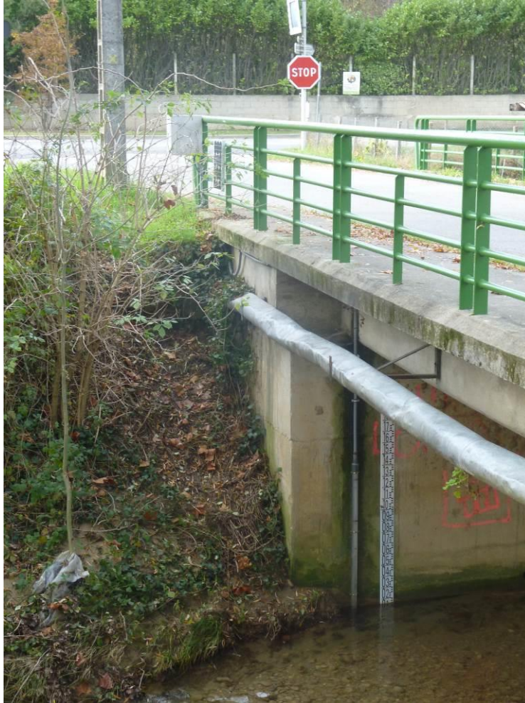
Figure 3 : Station hydrométrique de la DREAL sur le pont des Plantards à Châtillon Saint Jean
