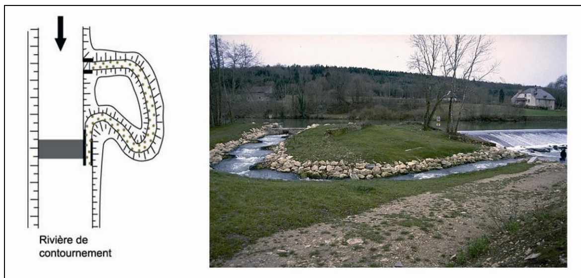
Figure 6 : Illustration et schéma de principe d'une rivière de contournement (source Guide technique pour la conception des passes naturelles, 2006)
