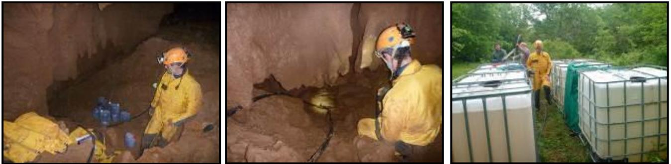
***Figure 98 : Photographies de l'injection de la sulforhodamine B (en cubitainers) au fond de la perte RB1 et du dispositif d'injection mis en place pour pousser le traceur (cuves)***
