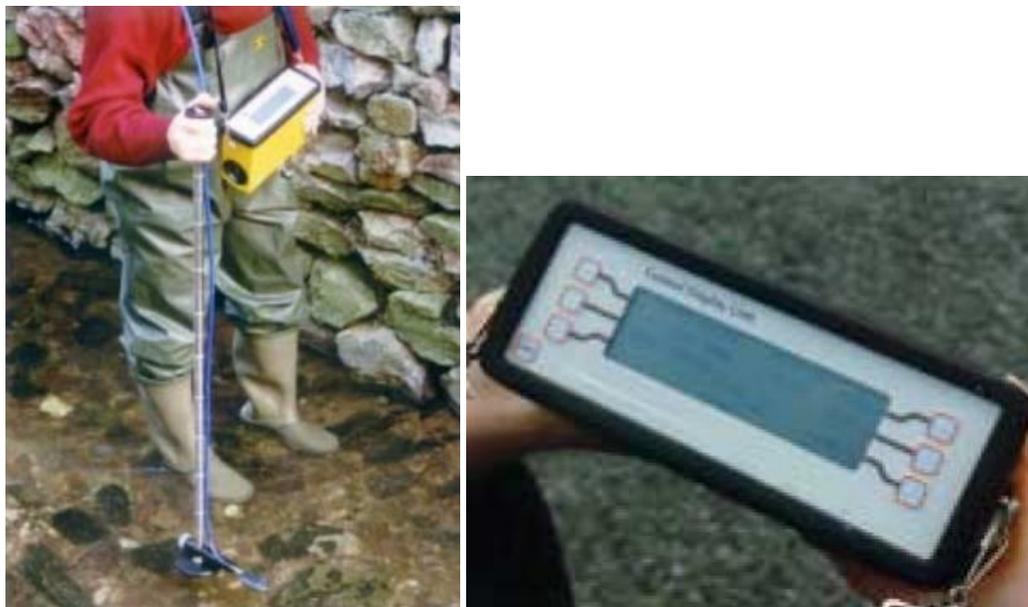
**Figure 21 : Photographie fournisseur du courantomètre électromagnétique HYDREKA)**
