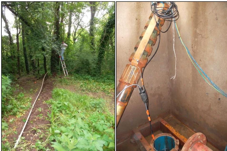
***Figure 106 : Installation du boîtier d'acquisition avec antenne GSM à l'extérieur du forage dans un arbre (à droite) et de la sonde du fluorimètre dans le forage F1 de Gerbial (à gauche)***
