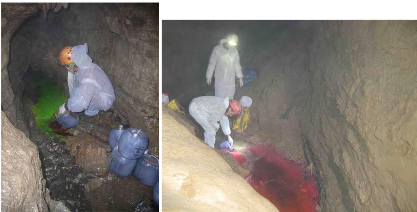
***Figure 36 : Photographies prises lors de l'injection de la fluorescéine à la Combe Rajeau (à gauche) et de la sulforhodamine B à la grotte du câble (à droite) le 10/06/2015***
