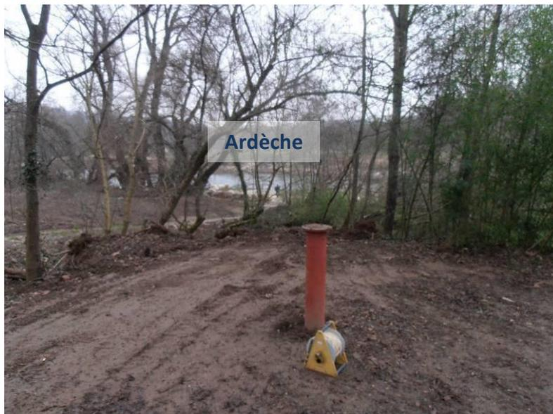
***Figure 80 : Photographie du piézomètre du Bœuf***
