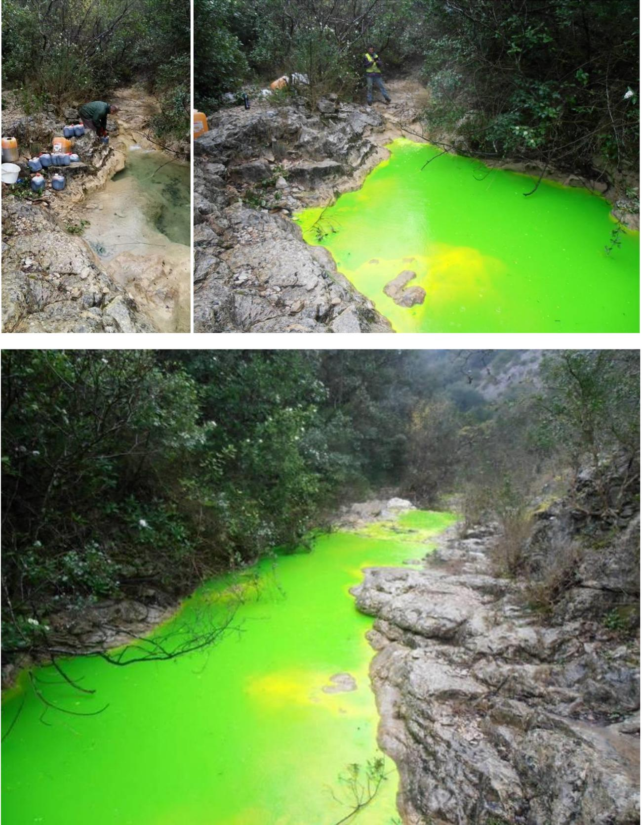
***Figure 65 : Photographies de l'injection de fluorescéine au ruisseau du Baravon (en haut à gauche : préparation avant injection ; en haut à droite et en bas : quelques minutes après injection)***
