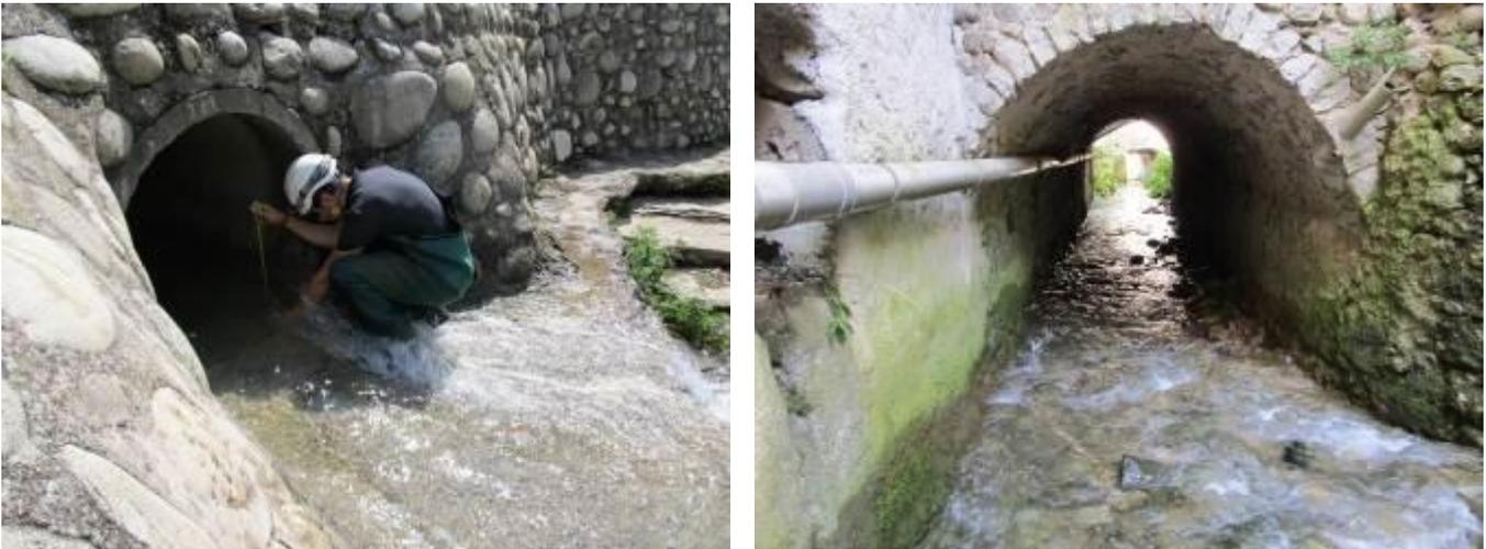
**Figure 30 : mesure des hauteurs d'eau au niveau des sources Estugnes Nord et Sud**
