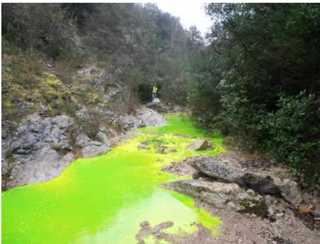
***Figure 15 : Injection de fluorescéine au ruisseau du Baravon (16/03/2016) - traçage vallée de l'Ibie***
