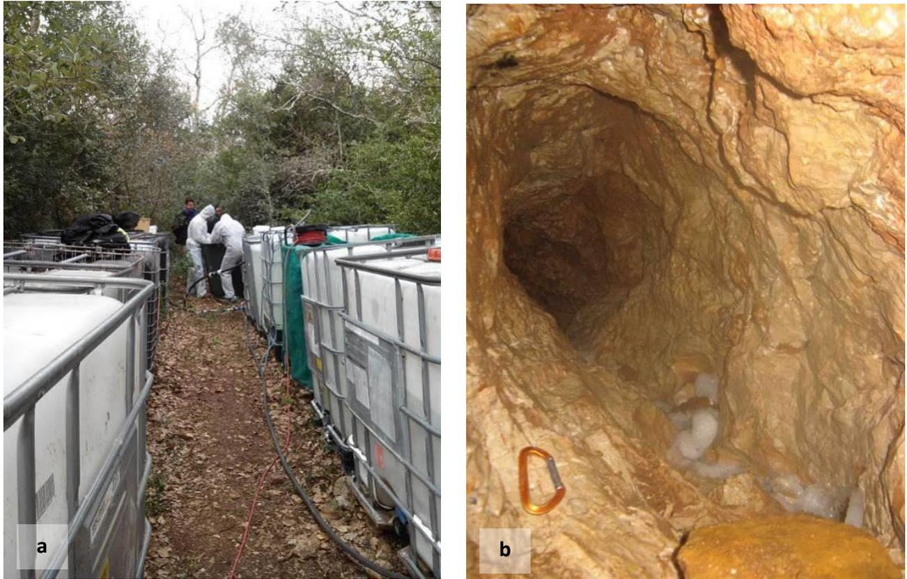
***Figure 63 : Photographies prises lors de l'injection d'acide amino G à l'aven Vitalie, préparation du traceur (a), vue dans l'aven au point d'injection par les spéléologues (b)***
