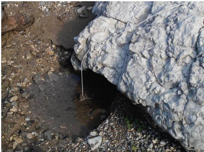
Les fluo-capteurs, composés de charbon actif, sont supposés pouvoir adsorber les traceurs fluorescents.
