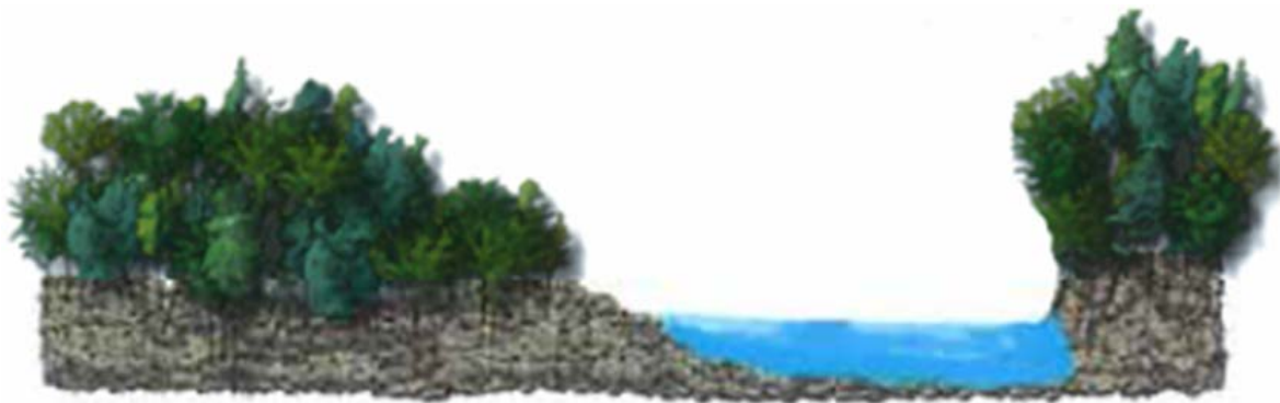
Figure 4 – Exhaussement et fixation par la végétation de l'atterrissement, incision du lit, affouillement de la rive droite, chenalisation du cours d'eau (source : CE3E)
