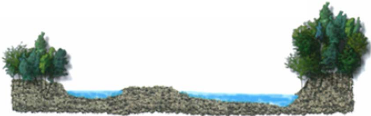
Figure 3 – Fonctionnement morphologique équilibré du cours d'eau : atterrissement central bas et non végétalisé (source : CE3E)
