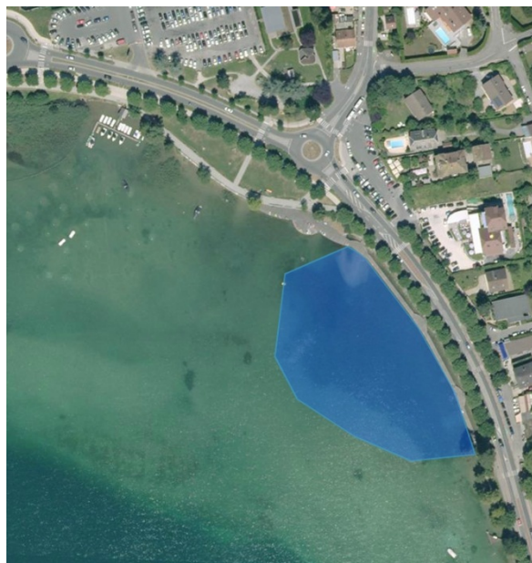
Surface de dilution potentiellement nécessaire pour l'atteinte de la qualité "bon état" des rejets des RUPT du bv n° 360 – Est ruisseau de la Pesse. (prise de vue Google Maps)
