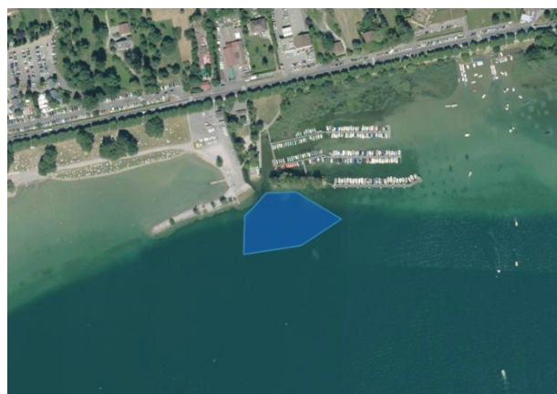
Surface de dilution potentiellement nécessaire pour l'atteinte de la qualité "bon état" des rejets des RUPT du bv n° 358 – ruisseau du Colovry. (prise de vue Google Maps)
