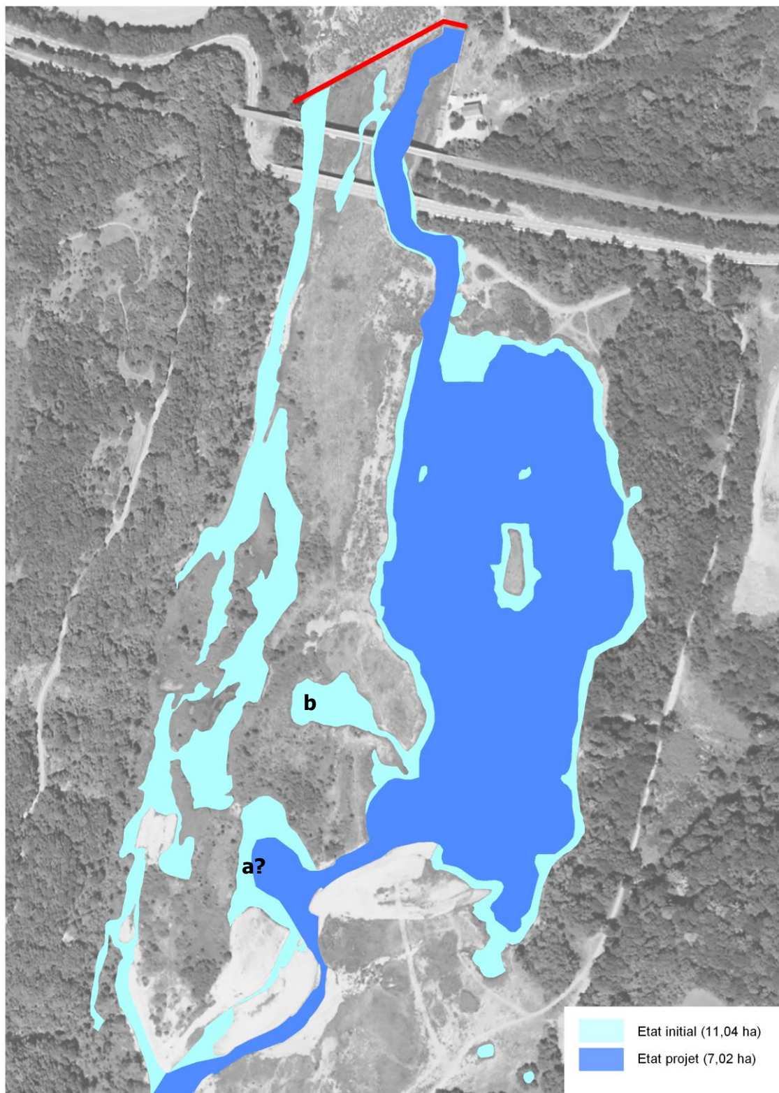
SCENARIO B - Evolution des surfaces en eau en cas d'effacement du seuil
