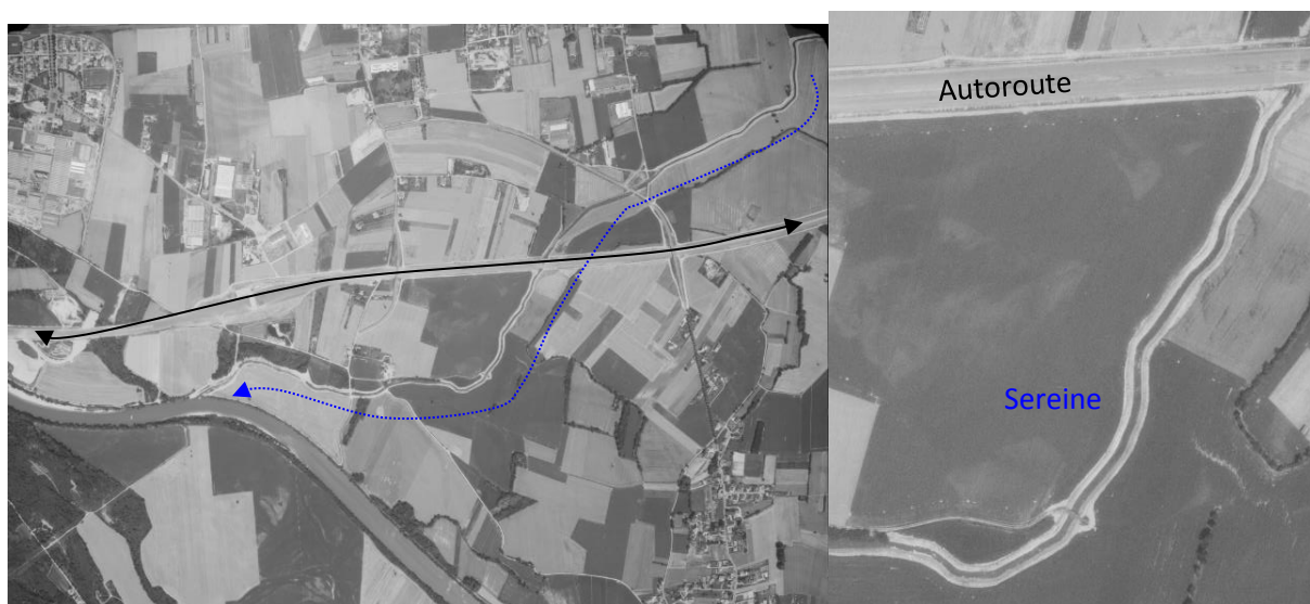
Figure 4 - Travaux de la Sereine aval entre La Boisse et le Canal de Miribel : rectification, recalibrage, endiguement – Images aériennes de 1982 lors des travaux de l'autoroute)
