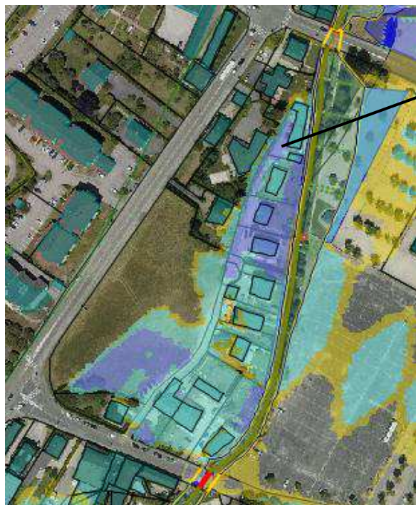
Q100 avec mur calé pour Q30
