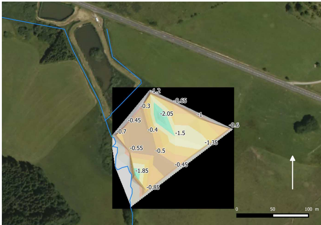
Figure 2: Modèle Numérique de Sub-Surface du Marais du Jorat. Echelle du sondage en mètre.
