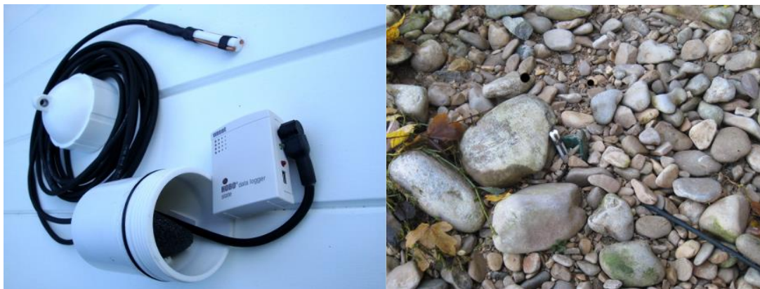
Figure 3 Capteurs utilisés pour déterminer les fréquences et durées d'assèchements
