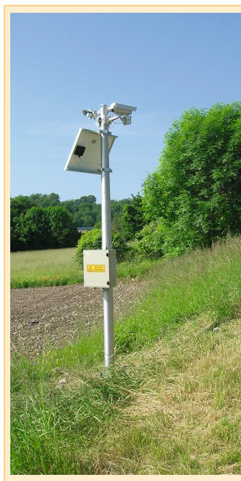
Ci-dessus : Mât avec à sa tête capteur infrarouge et caméra pouvant détecter des animaux.
