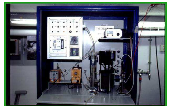
Figure 67 : Appareillage d'enregistrement et d'analyse pour un Biosensor (Source www.ists.unu.edu ).
