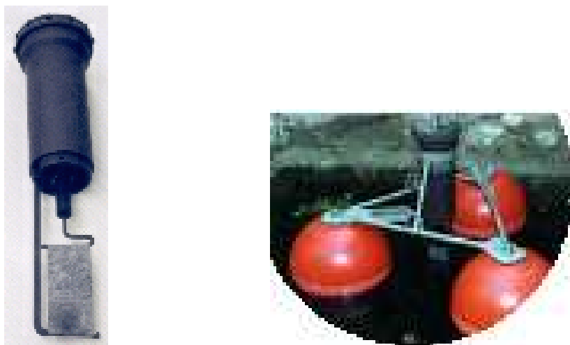
Figure 54 : Sonde « Oilspy » seule à gauche, et avec son système de flotteurs à droite (Source NEREIDES).
