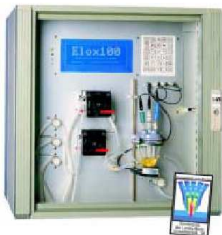
Figure 30 : Analyseur de DCO par oxydation de la matière organique par des radicaux hydroxydes (Source ANAEL S.A.S.).
