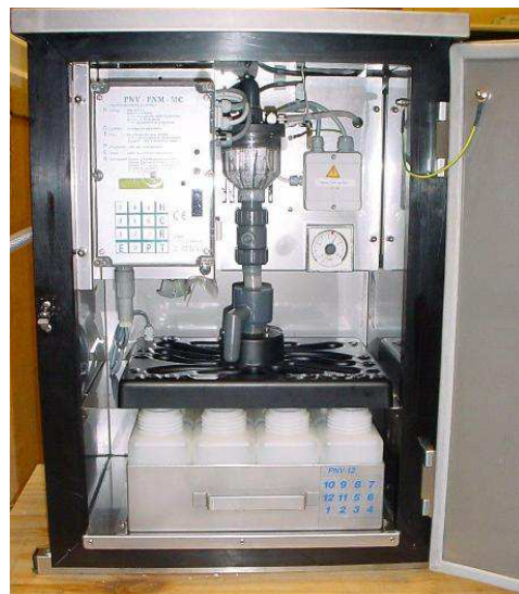
Figure 5 : Illustrations de préleveurs échantillonneurs multi-flacons réfrigérés (document ISMA).
