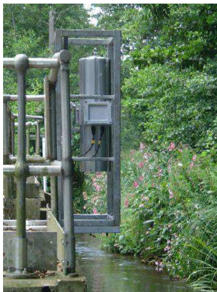
Figure 50 : Détecteur d'hydrocarbures utilisant un laser (Source ISMA).
