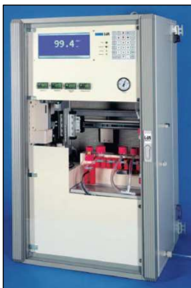
Figure 26 : Analyser de DCO et COT Haute Température (Source ANAEL S.A.S.).
