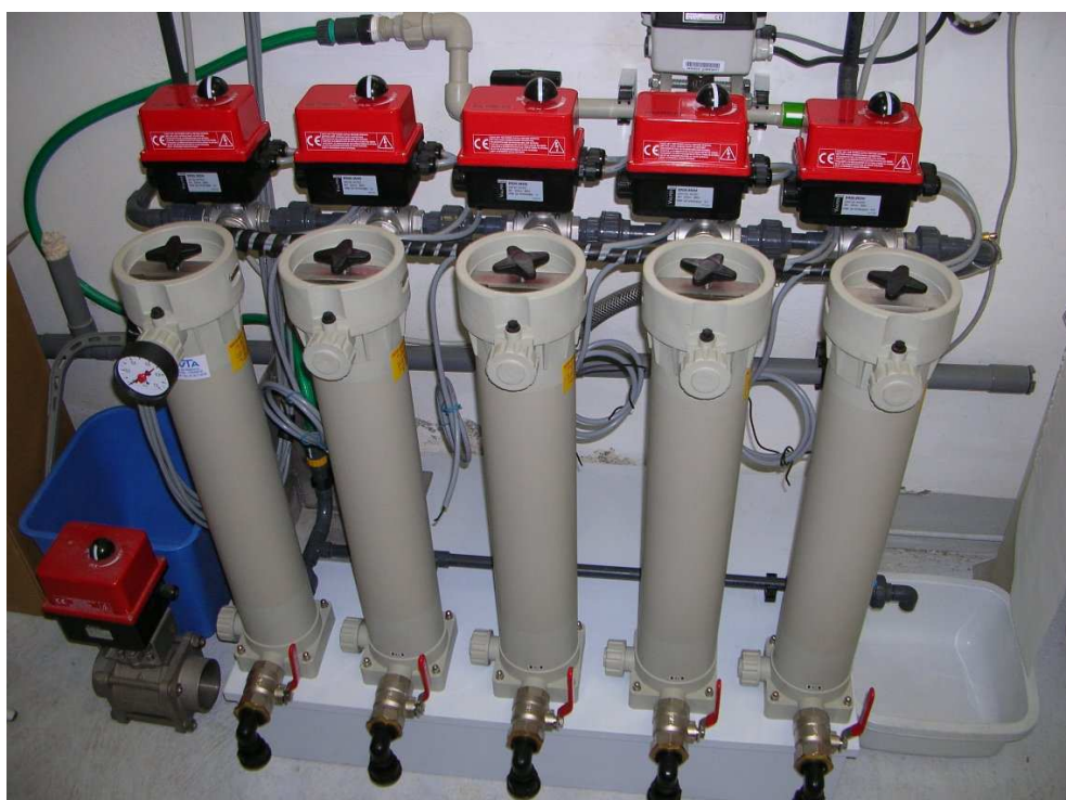
Figure 90 – Dispositif de 5 filtres en parallèle pour échantillonnage discret des MES en crue à Arles.
