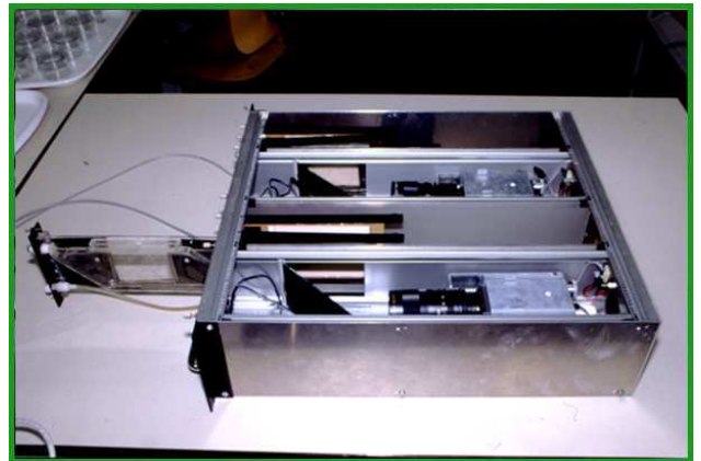
Figure 65 : Exemple d'appareillage vidéo pour la surveillance des poissons d'un BehavioQuant (Source www.ists.unu.edu ).
