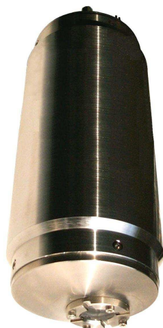
Figure 51 : Sonde de mesure des HAP surnageants ou dissous par fluorimétrie (Source sonde FLUO-HAP de AquaMS).
