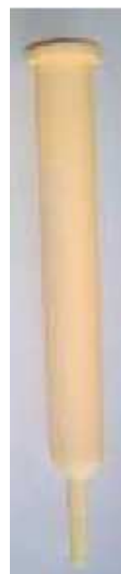
Figure 32 : Sonde d'analyse de l'azote total selon le procédé haute température (Source ANAEL S.A.S.).
