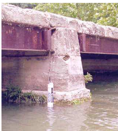
Figure 10 : Exemple d'implantation d'une sonde de mesure multicritères dans un cours d'eau (Source OTT).
