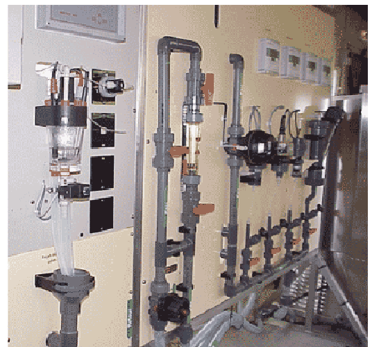
Figure 35 : Appareil de mesure de l'ammoniaque par potentiométrie (Source Polymétron).
