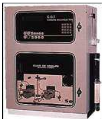
Figure 19 : Appareil de mesure du carbone organique total (Source SERES).
