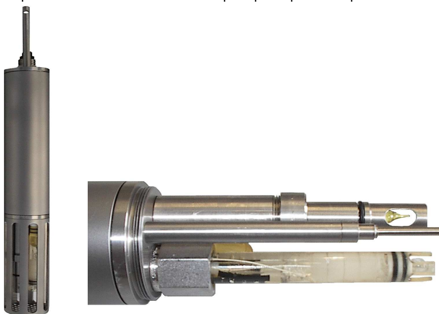
Figure 55 : Sonde de mesure du sulfure total dissous par ampérométrie. Vue générale à gauche et détail des sondes à droite (Source AquaMS).
