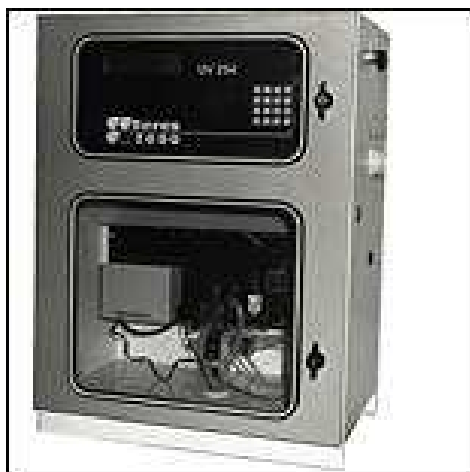
Figure 20 : Appareils de mesure de l'absorption UV à 254 nm (Source SERES à gauche et WTW à droite).
