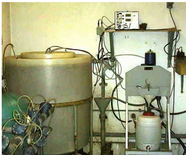
Figure 58 : Appareil de suivi de la radioactivité de l'eau pour le site de Meyrin (Source IRSN).
