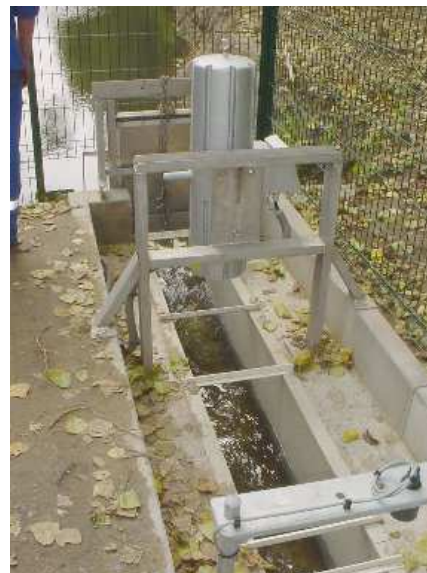
Figure 50 : Détecteur d'hydrocarbures utilisant un laser (Source ISMA).
