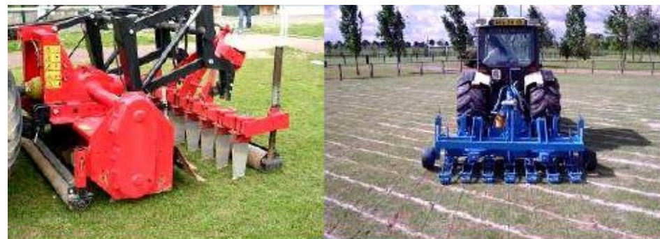
Décompacteur à lames fixes, vibrantes ou non
